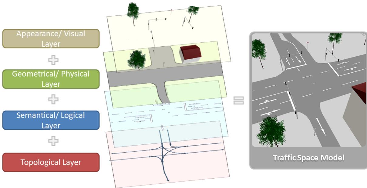
**Abbildung 4.3** – Aufbau eines Verkehrsraummodells für Verkehrs- und Fahrsimulationen bestehend aus vier Layern
