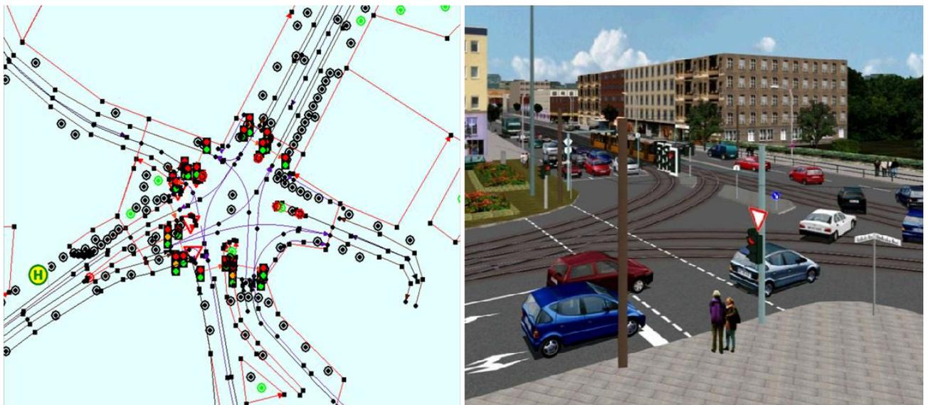
**Abbildung 1.2** – Modellierung einer komplexen Kreuzung im urbanen Bereich (links: Simulationsgraph des Verkehrsnetzwerkes, rechts: resultierende 3D-Szene) [Gröger et al., 2012, S.127]
