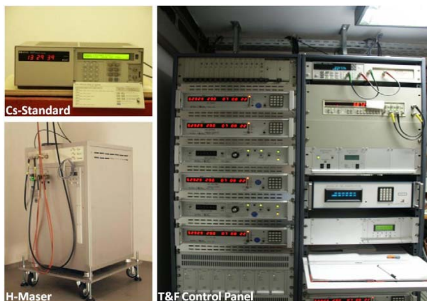
Abbildung 13: Die heutige Zeit- und Frequenzverteilung in Wettzell basiert auf mehreren H-Masern und Cs-Frequenznormalen, die mit einer Masterclock verglichen werden.
