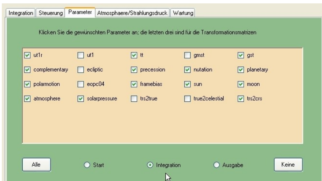
Bild 12: Einzelne Effekte können für die Integration aktiviert oder deaktiviert werden. Das Gleiche gilt auch für die anfängliche Transformation der Startwerte ins Inertialsystem („crs“) bzw. die evtl. für jeden Ausgabewert gewünschte Transformation aus dem Inertialsystem heraus. Damit können auch Startwerte, die nicht im Bezugssystem der Integration gegeben sind, korrekt verwendet werden bzw. die Ergebnisse auch in einem anderen Bezugssystem ausgegeben werden.
