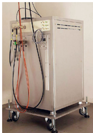
Abb. 13: Wasserstoffmaser, ein hochgenauer Frequenz-generator
