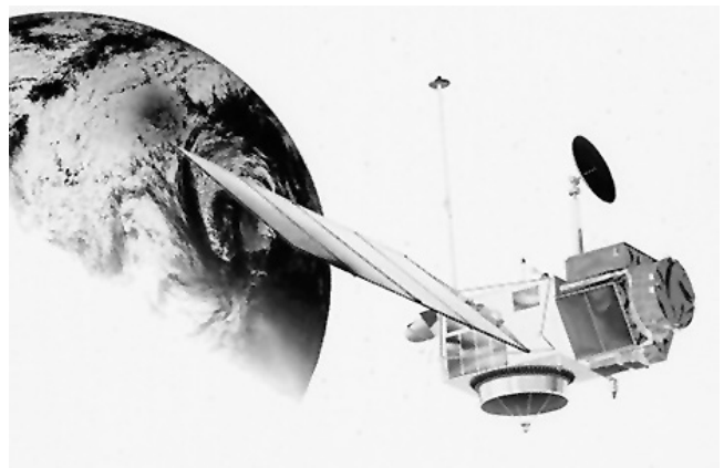
Abb. 3.10: Topex/Poseidon. Der Satellit wiegt 2169 kg und hat die Abmessungen 5.5 \times 6.6 \times 11.5 m.
