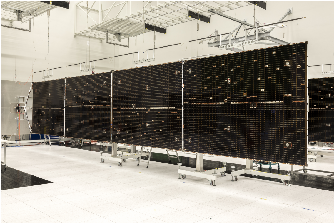
Abbildung 1.2: Ein Flügel eines typischen Solargenerators für Telekommunikationssatelliten belegt mit \text{GaInP}_2/\text{Ga(In)As}/\text{Ge} -Dreifachsolarzellen. Photograph: Jürgen Dannenberg, ©Astrium GmbH.
