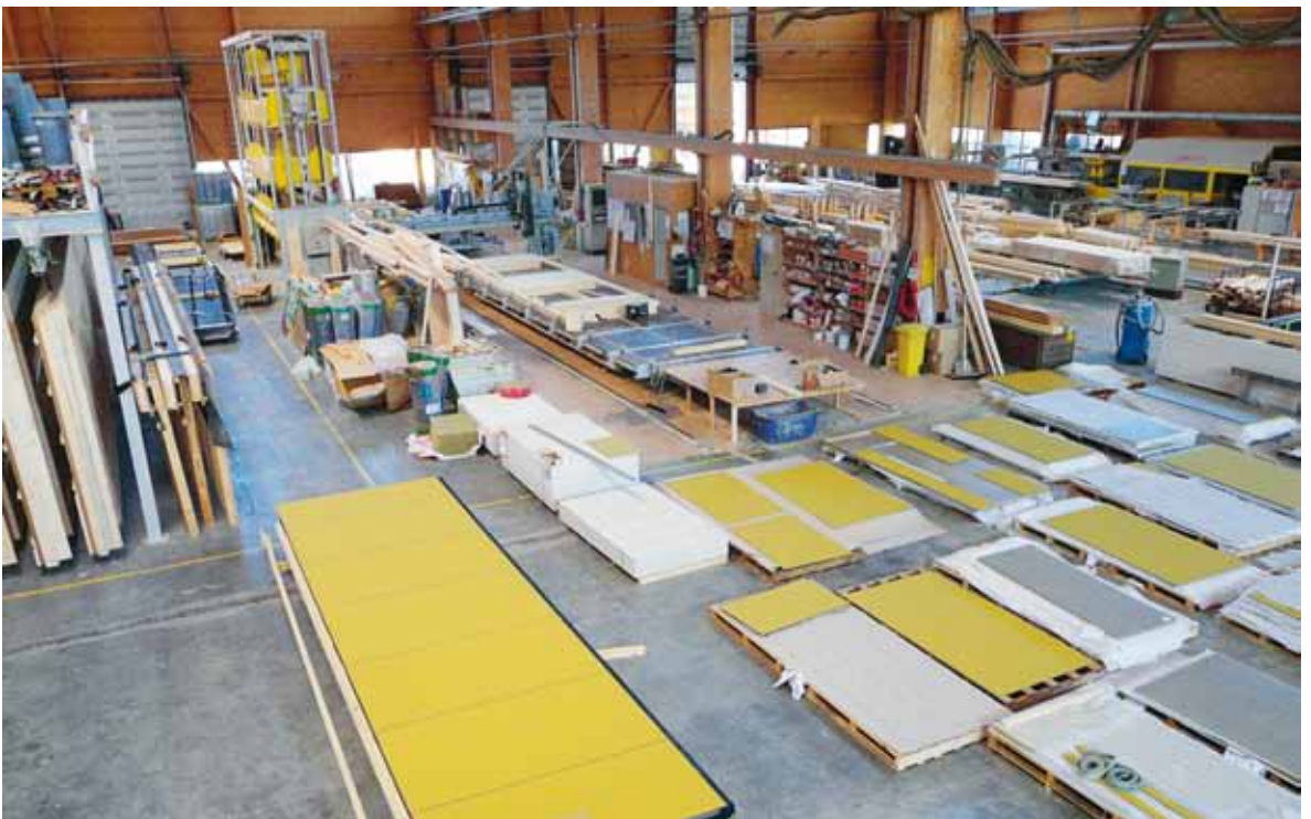
Vorfertigung und Montage TES Fassadenelemente für Schulsanierung Gundelfingen Prefabrication and assembly of TES façade elements for the restoration of a school in Gundelfingen
