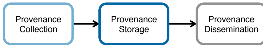
Abbildung 5.1: Komponenten einer Data-Provenance-Infrastruktur
