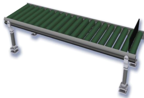
Abbildung 6-47: Förderer mit Stoppfunktion
