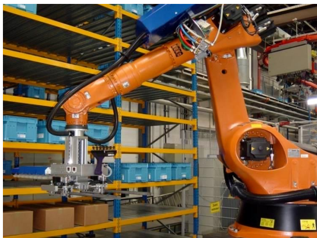
Abbildung 7-2: Roboter mit Greifer vor dem Hochregallager der Versuchsanlage
