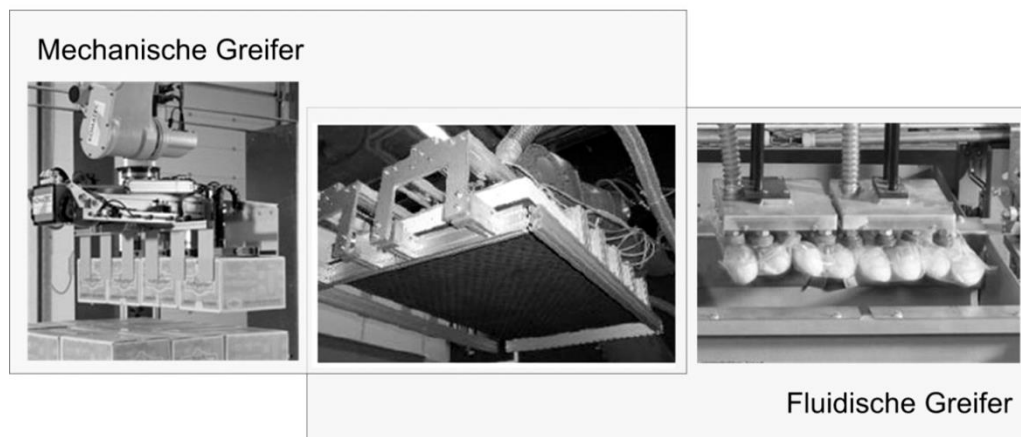
Abbildung 3-10: Mechanische und fluidische Greifer [Sch-06b]
