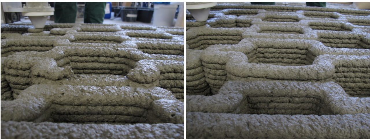
Abbildung 53: Fehlstelle in der Raupe (links) ist nach zwei weiteren Schichten (rechts) gut ausgeglichen
