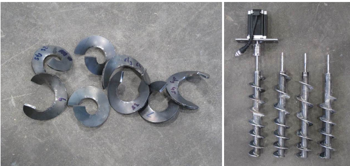
Abbildung 8: Auf Maß gefertigte Schneckenflügel (links) und fertig geschweißte Förderschnecken (von links nach rechts) b (mit Motor), c, d und i (rechts)
