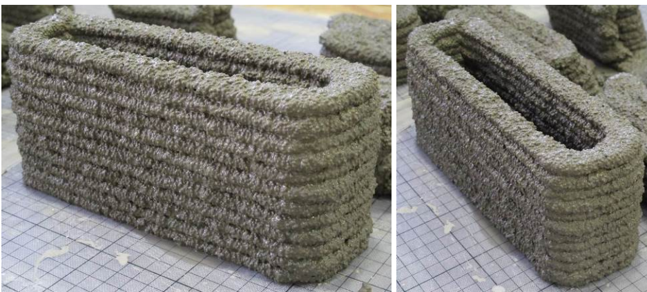
Abbildung 18: Hohlkastenprofil aus extrudiertem Leichtbeton, hier aus einem Leichtbeton mit der Gesteinskörnung Blähglas Liaver, Körnung 1 - 2 mm
