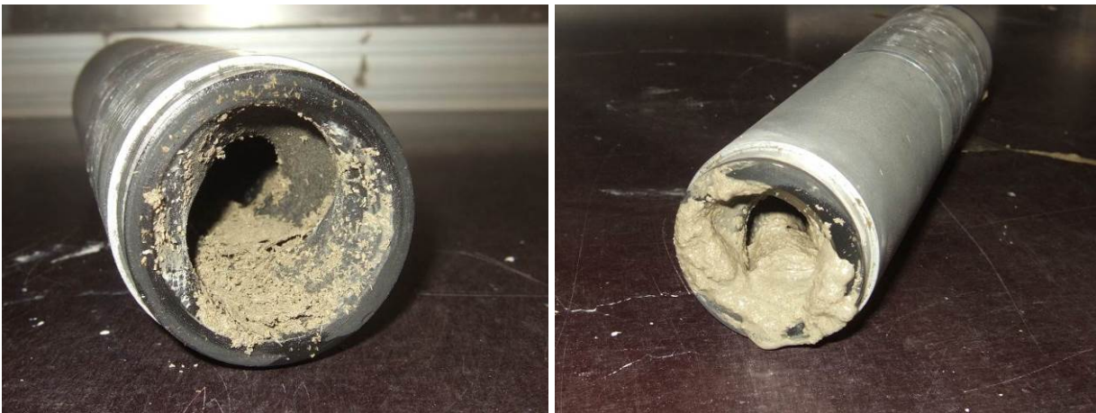
Abbildung 24: Stator des ViscoTec Dispenser 3VMP22 nach dem Versuch mit Arbocel C320 und SCHWENK Portlandkalksteinzement. Entwässerter Spanrückstand an der Saugseite (links) und spanreduzierter Frischbeton an der Druckseite (rechts) (Bauer 2015).
