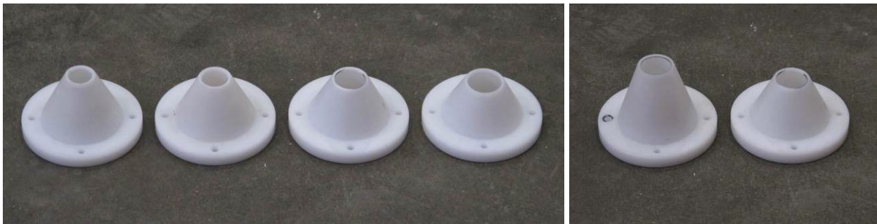
Abbildung 12: Düsen mit gleicher Flankenneigung (20°) und unterschiedlichem Öffnungsdurchmesser (17,5 mm, 20 mm, 22,5 mm und 25 mm) (links) und Düsen mit gleichem Öffnungsdurchmesser (22,5 mm) und unterschiedlicher Flankenneigung (15° und 20°) (rechts)
