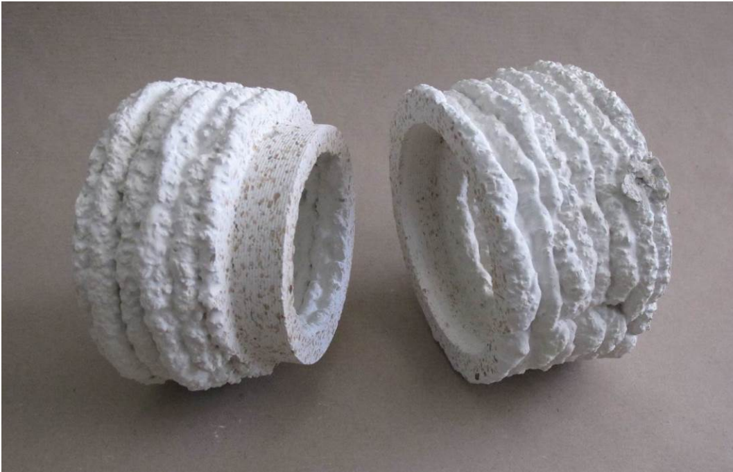
Abbildung 49: Durch Extrusion additiv gefertigtes und mittels Fräsen partiell subtraktiv nachbearbeitetes Bauteil aus Holzleichtbeton (WUTZ Spezialzement für Holzbeton und Buchenspäne Lignocel HB 500-1000). Extrusion und Fräsen erfolgten beide auf dem BZT PF 1000-P Portalsystem. (Modell aus Stanglmayr 2015)
