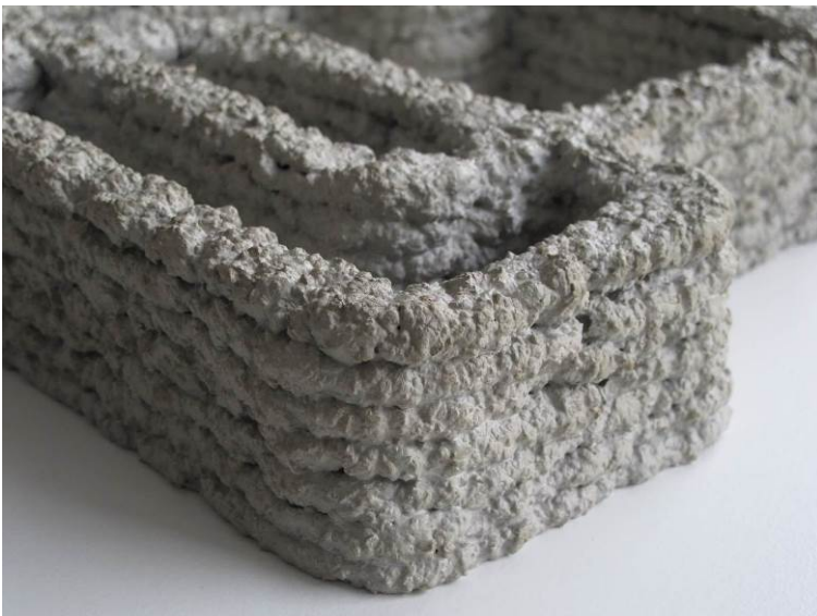
Abbildung 29: Durch Extrusion eines Leichtbetons mit der Gesteinskörnung CEMWOOD CW 1000 gefertigtes Bauteil (Modell aus Immel 2015)
