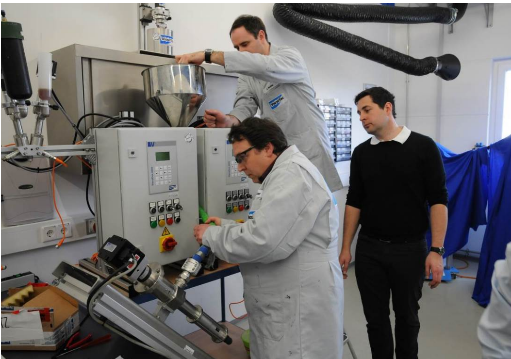
Abbildung 22: Versuche mit Exzentrerschneckenpumpe ViscoTec Dispenser 3VMP22 im Technikum der ViscoTec Pumpen- u. Dosiertechnik GmbH
