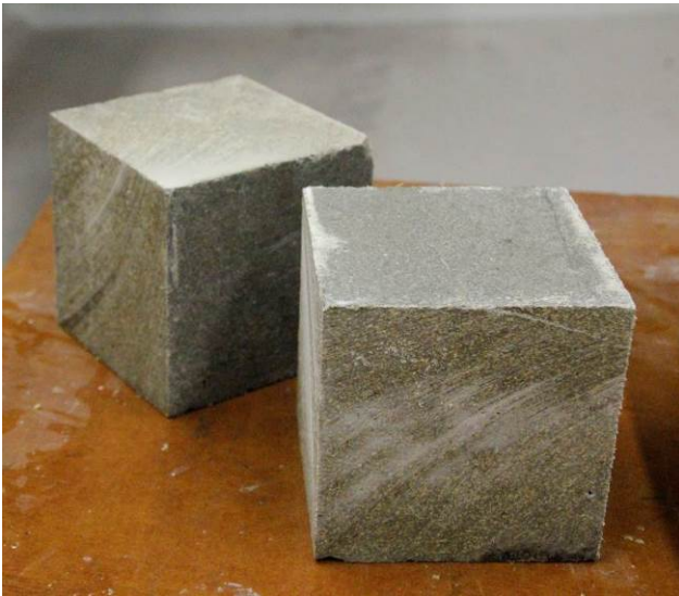
Abbildung 38: Gedruckte und auf Maß geschnittene Probekörper für die Prüfung der Druckfestigkeit
