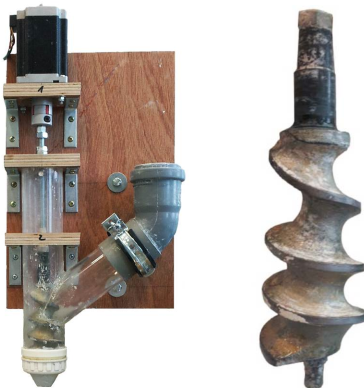
Abbildung 6: Extruder II (links) und im Extruder II eingesetzte Förderschnecke aus einem Fleischwolf (rechts) (Talke 2014)
