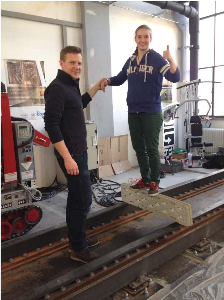
Abbildung 51: Ergebnis eines Vorversuchs mit sechs Schichten der Schichtgeometrie A, Demonstration der Festigkeit durch Einsatz als Träger über eine Spannweite von 70 cm
