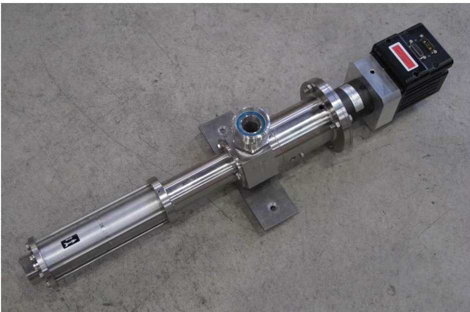
Abbildung 5: Extruder I mit Exzentrerschneckenpumpe ViscoTec Dispenser 3VMP22
