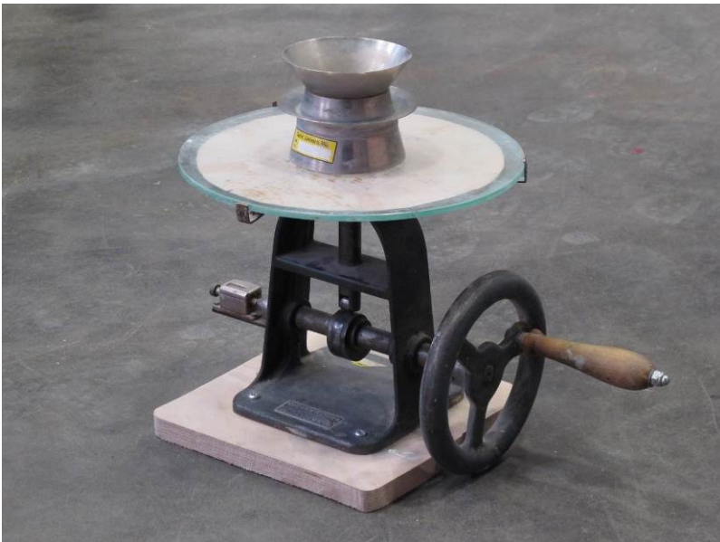
Abbildung 35: Hägermann-Ausbreittisch für Handbetrieb, mit Zählwerk, Glasplatte und Setztrichter mit Aufsatz
