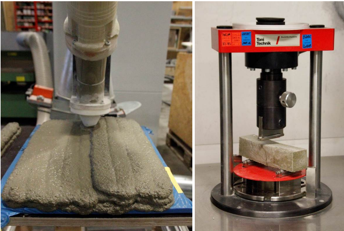
Abbildung 40: Drucken der Platten für die Herstellung von Prüfprismen (links) und Biegezugprüfung (rechts)
