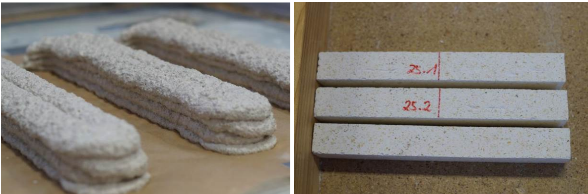
Abbildung 27: Probekörper für Biegezugversuche aus WUTZ Spezialzement für Holzbeton und Buchenspänen Lignocel HB 500-1000, gedruckte Rohlinge (links) und zugeschnittene Probekörper (rechts) (Strobel 2015)
