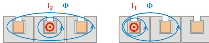
Abbildung 2.10: Schematische Darstellung der ungleichen induktiven Kopplungen
