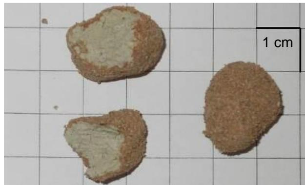
**Abb. 6.9:** Typisches Boden-Makroaggregat (hellgrau) mit Kruste aus RC-Material (braun)
