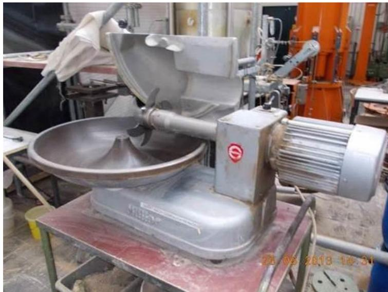
**Abb. 4.7: Kutter zur Einmischung des Wassers in die feinkörnigen Böden<sup>107</sup>**
