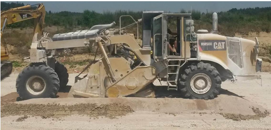
**Abb. 5.1:** Die Fräse CAT RM500 beim Großversuch; Bewegung von links nach rechts
