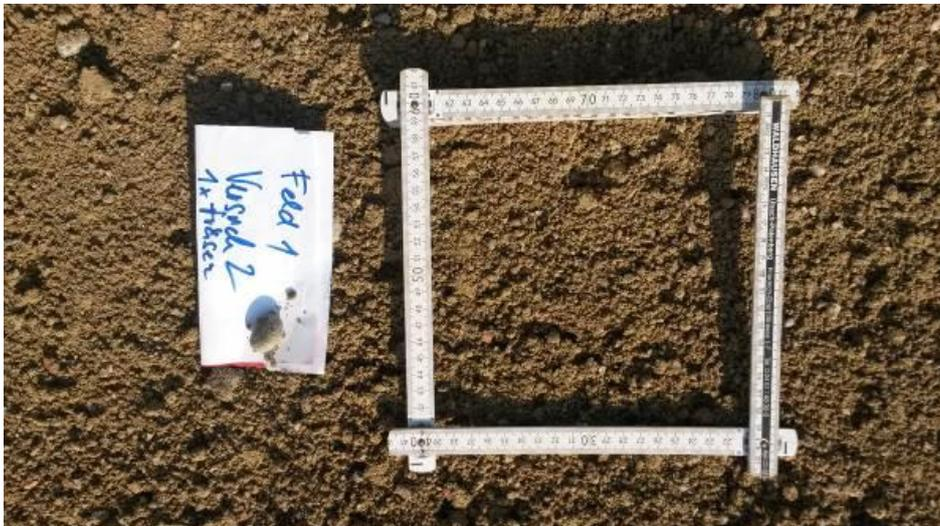
**Abb. 5.10:** Das Ergebnis der Fräsung im Versuch 2 nach 1 Fräsdurchgang
