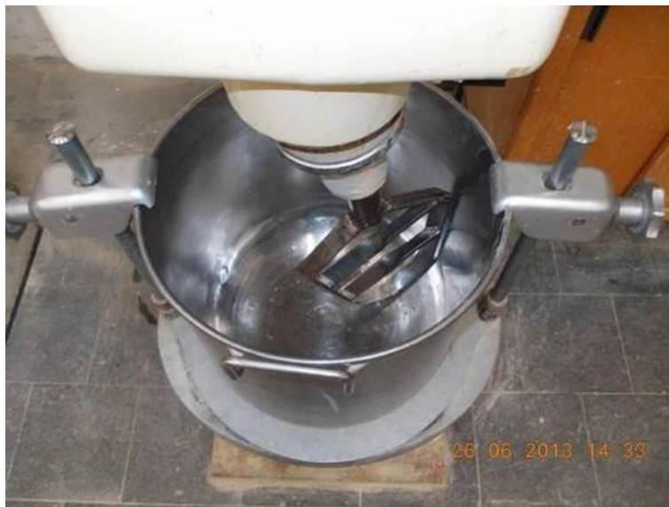
**Abb. 4.8:** Knetmischer zur Einmischung des RC-Materials in die feinkörnigen Böden<sup>108</sup>
