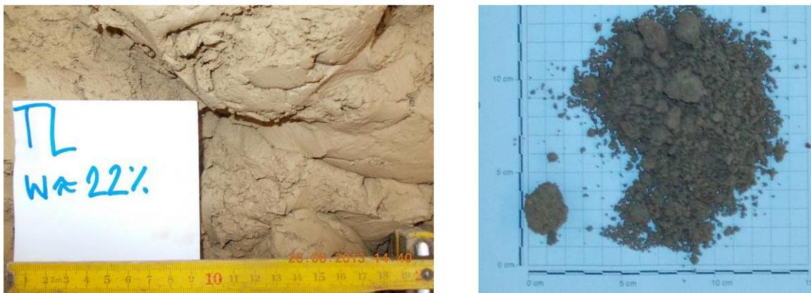
**Abb. 1.2:** Feinkörniger Boden vor und nach Mischung mit RC-Sand aus Bauschutt (RC-Mix 0/4)
