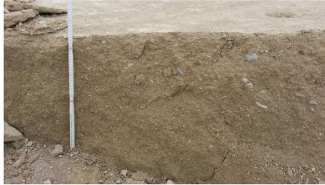
**Abb. 5.13:** Querschnitt durch die verbesserte Schicht nach der Nachuntersuchung
