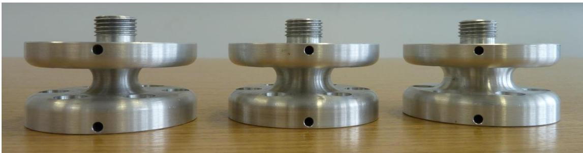
**Abb. 5.4:** Wärmeflussensor in Form verjüngter Aluminiumkörper.
