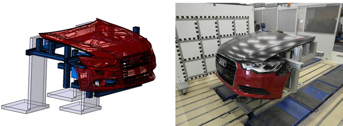
Abbildung 3.2.: Komponentenprüfstand „Vorderwagen“ zur Substitution von Gesamtfahrzeugversuchen
