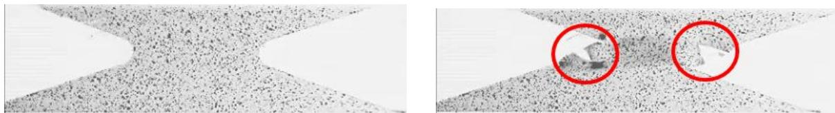
Abbildung 4.12.: Anrissverhalten von PC-PET unter hohen Dehnraten beim Schubversuch
