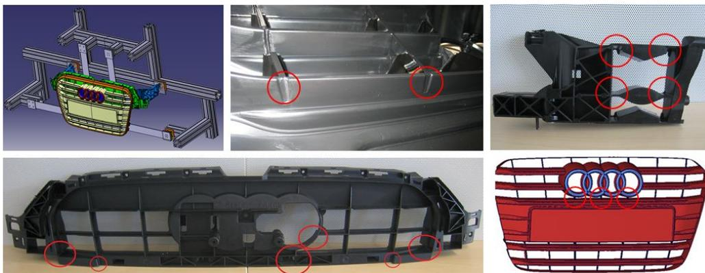
Abbildung 3.6.: Bruchauftreten an beschossenen Bauteilen auf dem Prüfstand „Komponente“
