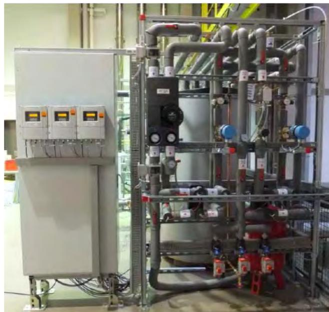
**Abbildung 2-4: Ansicht Versuchsstand für Mikro-KWK-Systeme – Verbraucherseite**
