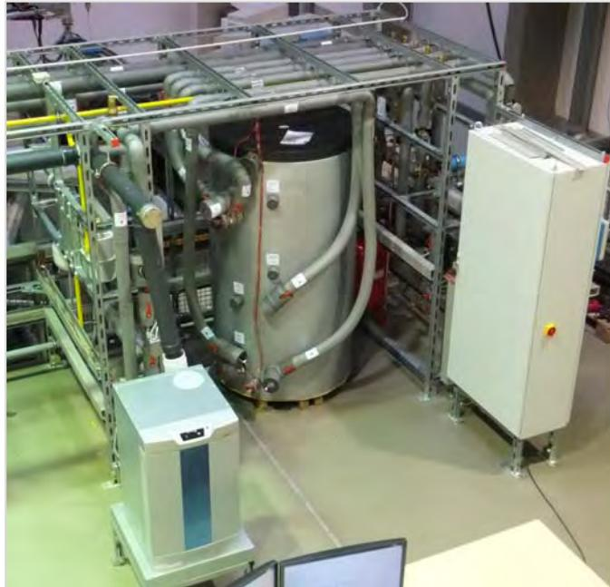
**Abbildung 2-3: Ansicht Versuchsstand für Mikro-KWK-Systeme**
