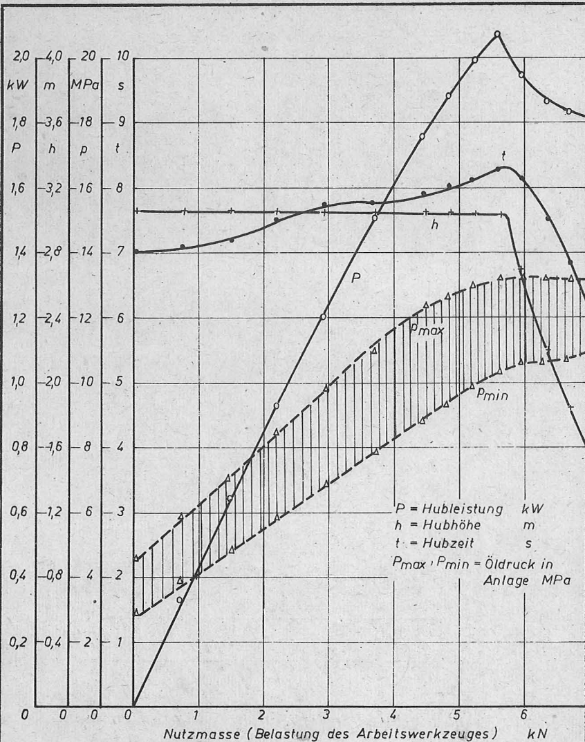
Hubcharakteristik des Laders IF 55-00 am Traktor U-550
