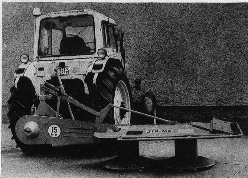
Rotormähwerk ZTR-165 (Schutz entfernt)
