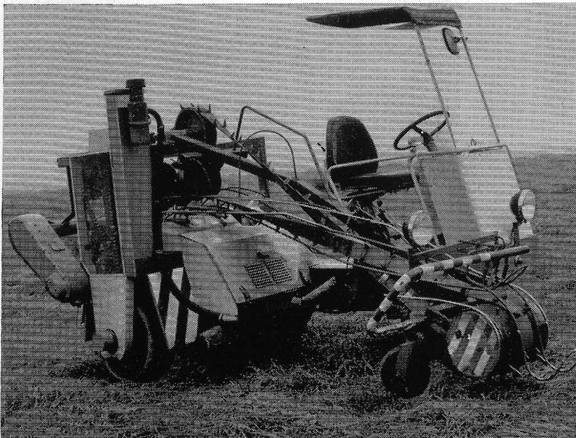
Flachsaufnahme-, -wende- und -bündelmaschine SOVL 1 a
