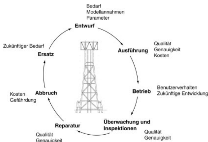
Bild 1. Unsicherheiten im Lebenszyklus eines Bauwerkes Fig. 1. Uncertain factors during the life-cycle of an engineering structure
