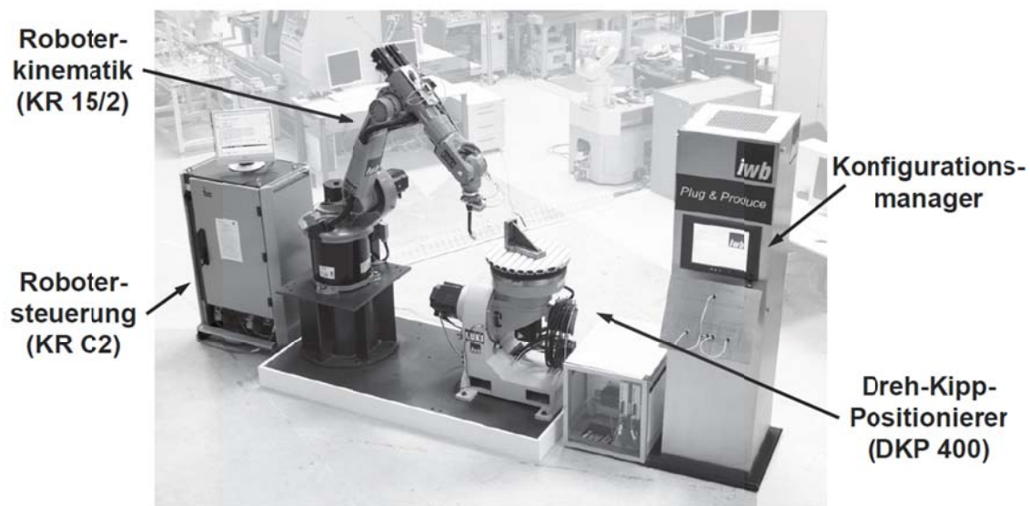
Abbildung 48: Versuchsstand des Referenzszenarios „Roboterbasiertes MIG/MAG Schweißen“ (KRUG 2013)
