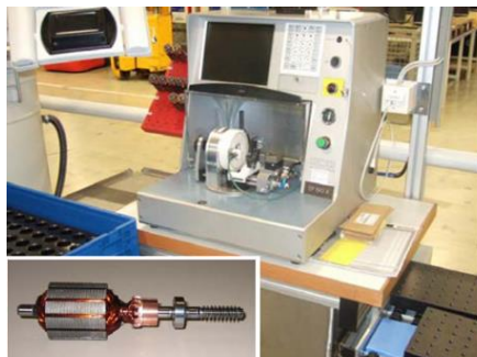
Elektrische Prüfung Anker
