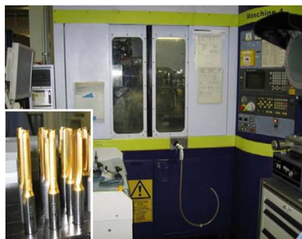
Beladung CNC-Maschine (Fräuserschleifen)
