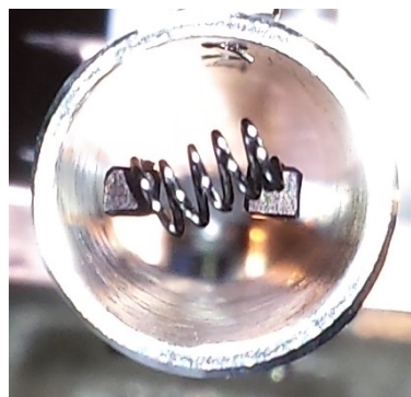
Abbildung 2.21: Tantalfilament punktgeschweißt am Ende der Molybdänstäbe.
