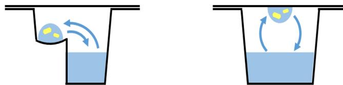
**Abbildung 14:** Prinzip von *sitting drop*- (links) und *hanging drop*-Kristallisationsverfahren.
