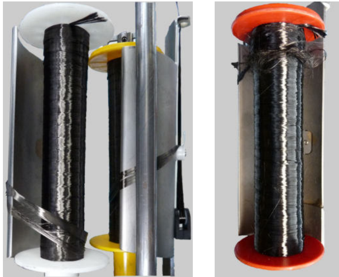
Abbildung 5.3: Faserschädigung durch schrägen Abzug der Fasern von der Spule; links: Aufspießen der Faser; rechts: Faserring auf der Spule
