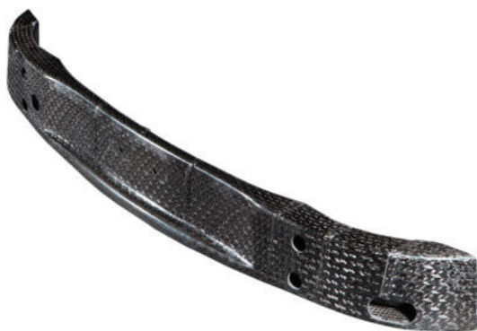
Abbildung 2.3: Geflochtener Stoßfängerträger eines BMW M3 (Quelle: BMW 1 )
