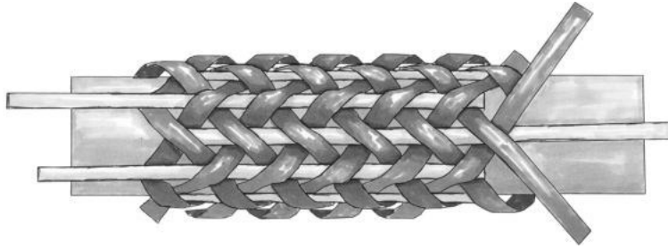
Abbildung 3.5: Triaxiales Rundgeflecht mit den zwei schräg verlaufenden Flechtfadensystemen und den Stehfäden
