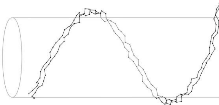
Abbildung 6.3: Zwei benachbarte Fäden nach der Simulation des Umflechtens eines runden Kerns
