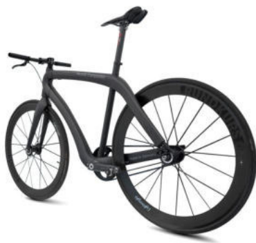
Abbildung 2.4: Fahrrad mit geflochtener Rahmenstruktur der Firma Munich Composites 1
