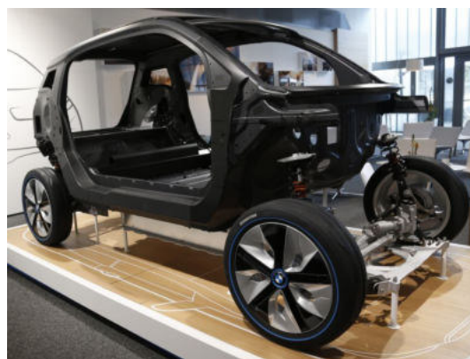
Abbildung 2.3: BMW i3 mit geflochtenen Strukturelementen zur Verstärkung des Dachrahmens (Quelle: BMW 1 )
