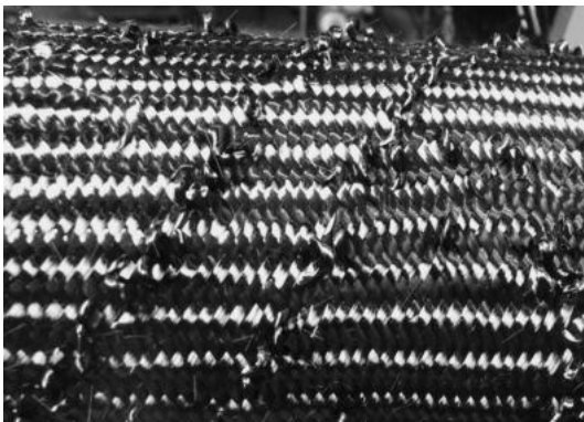
Abbildung 4.15: Schlaufen im Geflecht aufgrund zu geringer Stehfadenzugkraft
