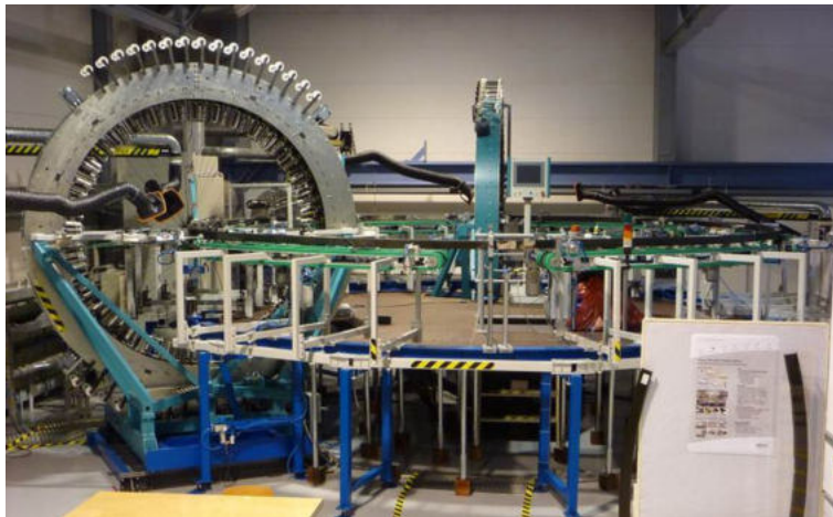
Abbildung 3.19: Produktionsanlage für Spante mit zwei Flechtmaschinen sowie einer UD-Zuführung und einer 90°-Wickeleinheit (Quelle: Airbus Group Innovations 1 )
