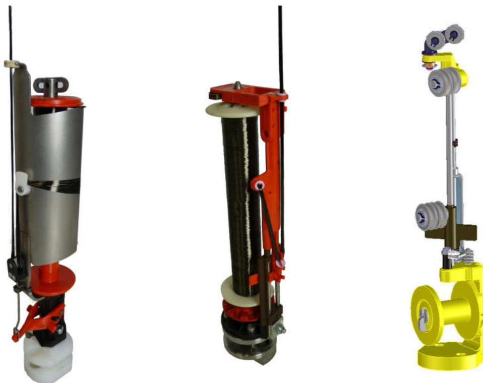
Abbildung 3.13: Darstellung von verschiedenen Klöppeltypen; links: Hebelklöppel; mitte: Schieberklöppel; rechts: Klöppel mit liegender Spule
