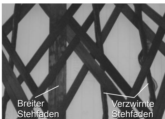
Abbildung 4.31: Aufgezwirnte bzw. nicht gezwirnte Stehfäden in der Flechtmaschine
