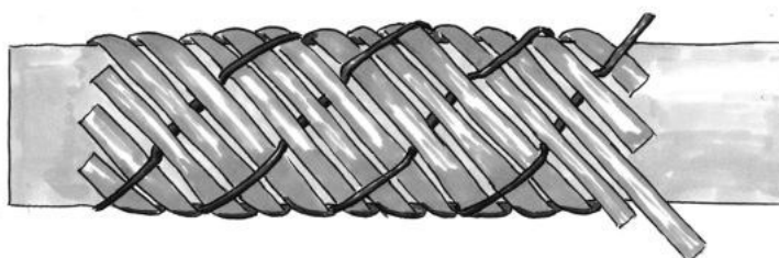
Abbildung 3.6: UD-Geflecht. Verstärkungsfasern verlaufen nur in einer Richtung
