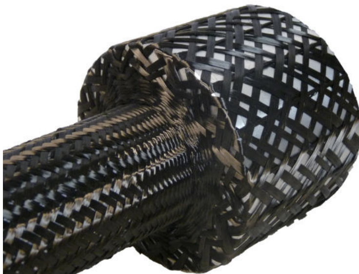
Abbildung 6.18: Überflochtener Flansch gemäß den durchgeführten Simulationen; das Geflecht schlägt am unterem Bereich des Flansches um, bedeckt diesen im oberen Bereich aber noch nicht vollständig.
