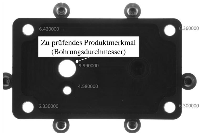
*Abbildung 47: Ergebnis der automatisierten Qualitätsprüfung des Getriebegehäuses*
