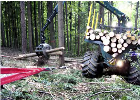
Abbildung 6: Durch eine Seilwinde am Tragschlepper kann die Traktion bei Fahrten am Hang unterstützt werden. Foto: M. Wolf
