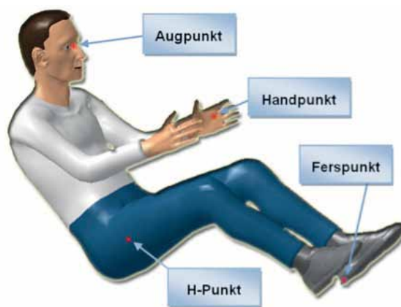
Abb.1: Digitales Menschmodell RAMSIS mit, für die Auslegung von Fahrerarbeitsplätzen relevanten Körperpunkten
