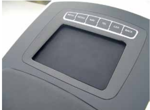
Abbildung 1: Touchpad mit haptischer Rückmeldung (so gezeigt auf der CES 2011 in Las Vegas)
