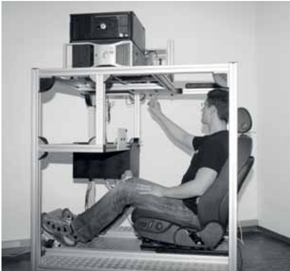
Abb. 5: Proband beim Betätigen des Drucktaster-Simulators in der vertikalen Einbaulage, in der schwarzen Box vor dem Probanden befindet sich der Drucktaster-Simulator für die horizontale Einbaulage.
