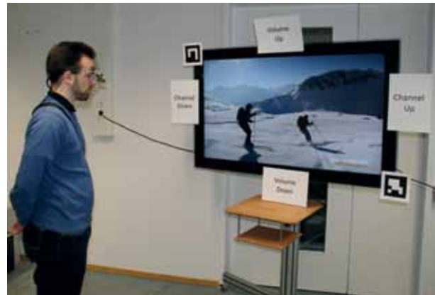
Abb. 5: Versuchsaufbau zum Steuern eines Fernsehers mit Hilfe der DIKABLIS-Blicksteuerung
