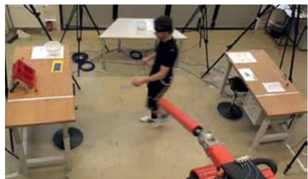
Abb. 3: Schaumstofffatrappe am TCP des Roboters.
