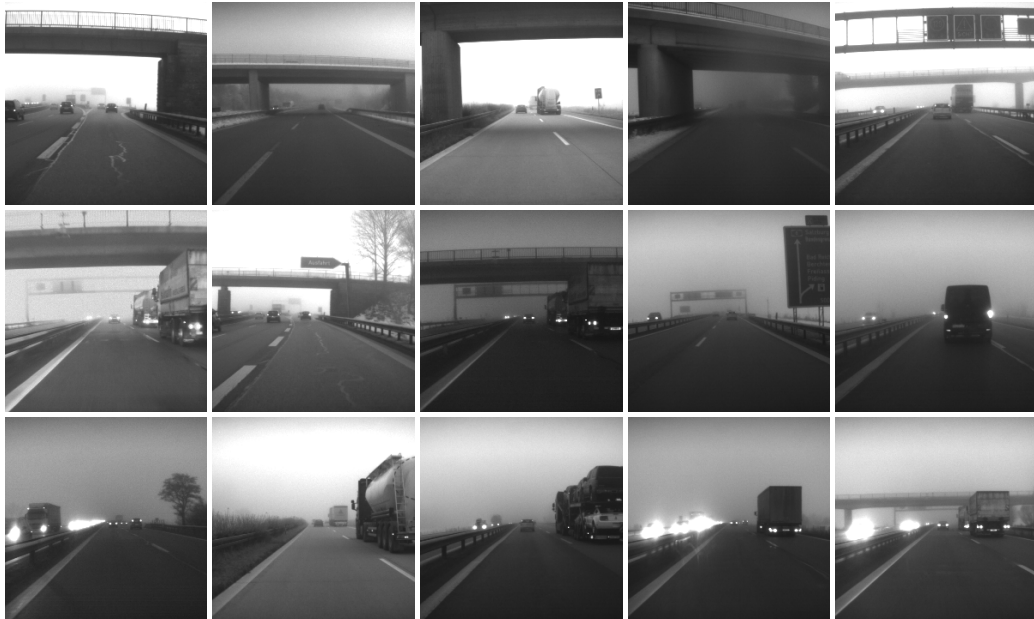
Abbildung 5.18: Beispiele für False Negatives bei Tag. Diese traten vor allem bei der Unterfahrung von Brücken und bei Überholvorgängen von Lastkraftwägen auf.
