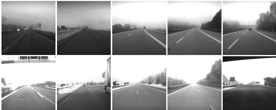
Abbildung 5.20: Beispiele für False Positives bei Tag. Diese traten vor allem bei leichtem Nebel und sporadisch bei überbelichteten Bildern auf.
