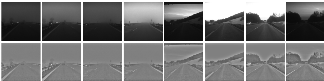
Abbildung 4.4: Vorverarbeitung am Beispiel jeweils zwei aufeinanderfolgender Bilder mit unterschiedlicher Beleuchtung aufgrund der automatischen Regelung der Kameraeinstellung. In der ersten Zeile sind die Kamerabilder dargestellt, in der zweiten Zeile das Ergebnis der Vorverarbeitung. In den vorverarbeiteten Bildern ist deutlich die Verminderung von Beleuchtungseffekten zu erkennen.
