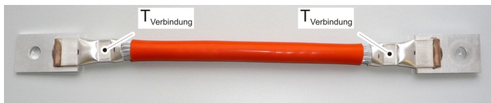
Abbildung 28: Temperaturmessstellen zur Bestimmung der Verbindungstemperatur für widerstandsgeschweißte Verbindungen
