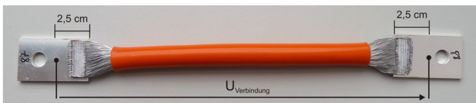
Abbildung 25: Spannungsabgriff zur Bestimmung des Gesamtwiderstands bei laserstrahl- und ultraschallgeschweißten Verbindungen
