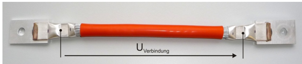
Abbildung 26: Spannungsabgriff zur Bestimmung des Gesamtwiderstands bei widerstandsgeschweißten Verbindungen
