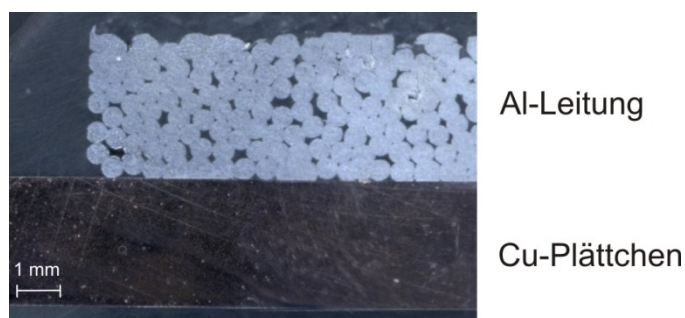
Abbildung 17: Querschliff einer ultraschallgeschweißten Verbindung mit versilberten Kupferplättchen. Dicke der Silberschicht: 6 \mu\text{m} (hier nicht sichtbar)
