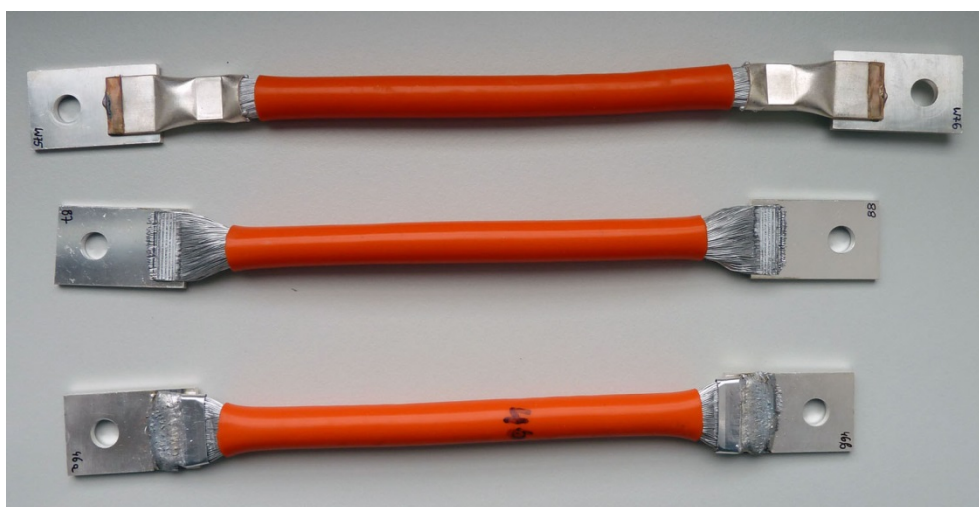
Abbildung 24: Von oben nach unten: Widerstandsgeschweißte, ultraschallgeschweißte und laserstrahlgeschweißte Doppelverbindung
