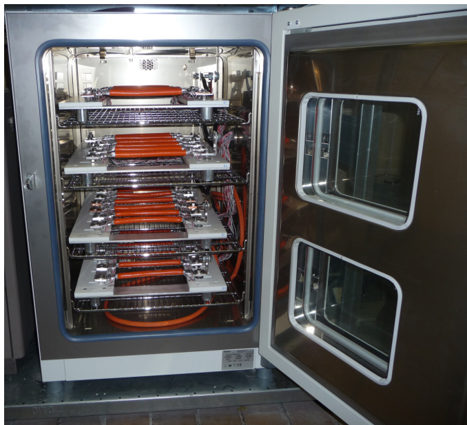
Abbildung 69: Wärmeofen mit unbelasteten Verbindungen zu Beginn des Versuchs
