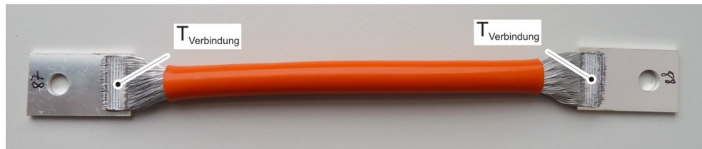
Abbildung 27: Temperaturmessstellen zur Bestimmung der Verbindungstemperatur für ultraschall- und laserstrahlgeschweißte Verbindungen
