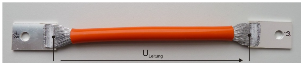
Abbildung 36: Spannungsentzug zur experimentellen Bestimmung des Widerstandsbelags der Leitung
