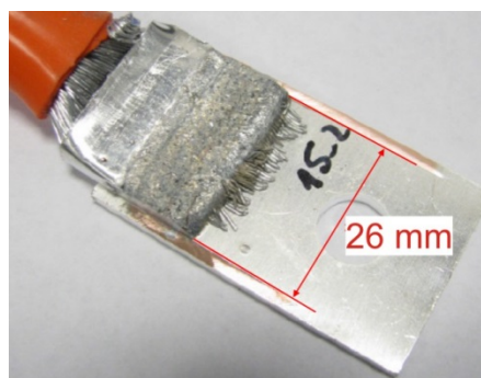
Abbildung 33: Seitlich abgefräste laserstrahlgeschweißte Verbindung vor der Durchführung eines Schälversuchs
