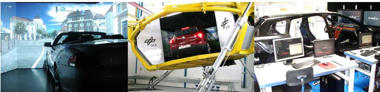
**Abb. 6-5** Fahrsimulatoren (von links nach rechts: statischer Fahrsimulator der Technischen Universität München [LFE, 2013], dynamischer Fahrsimulator des Deutschen Zentrums für Luft und Raumfahrt [DLR, 2013], statischer Fahrsimulator TECNALIA [LARBURU ET AL., 2012])
