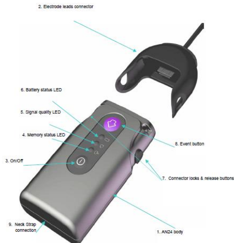
Abb. 5: Monica AN24™ Gerät mit dekonnektierbarem Verbindungsstück (schwarz) welches Kabel zu den Elektroden führt (Quelle: Monica Healthcare AN24™ Reference Operator Manual, Monica Healthcare Ltd. 2007-2009).
