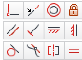
Abbildung 4.2: Symbole der geometrischen Zwangsbedingungen in Autodesk Inventor
