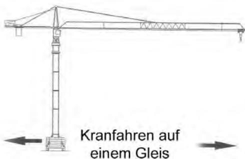
ABBILDUNG 18: KRANFAHREN BEI EINEM AUF EINE GLEISANLAGE MONTIERTEN TURMDREHKRAN
