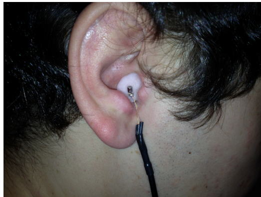
Abbildung 2.1.: Aufnahme der Schallwellen im Ohr mit einem Mikrophon
