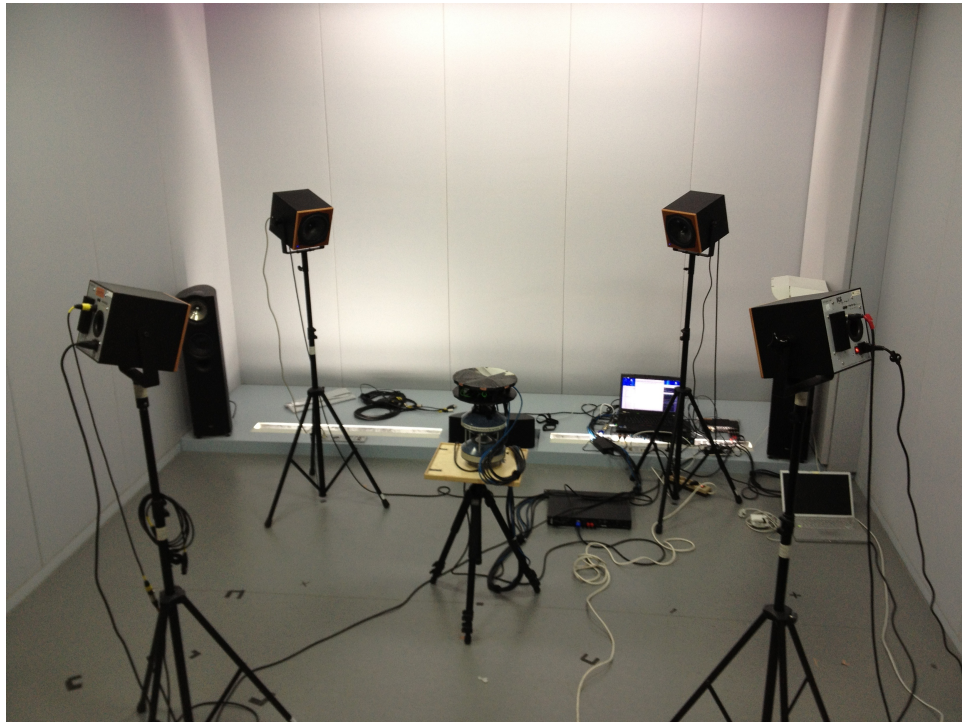
Abbildung 5.1.: Aufbau zur Aufnahme der Stimuli im Videolabor des LDV
