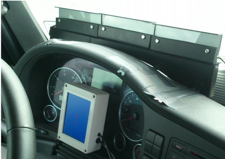
Abbildung 13: Ansicht der Ausgabegeräte: TFT Display im Kombiinstrument und LED Module auf der Kombi - Hutze
