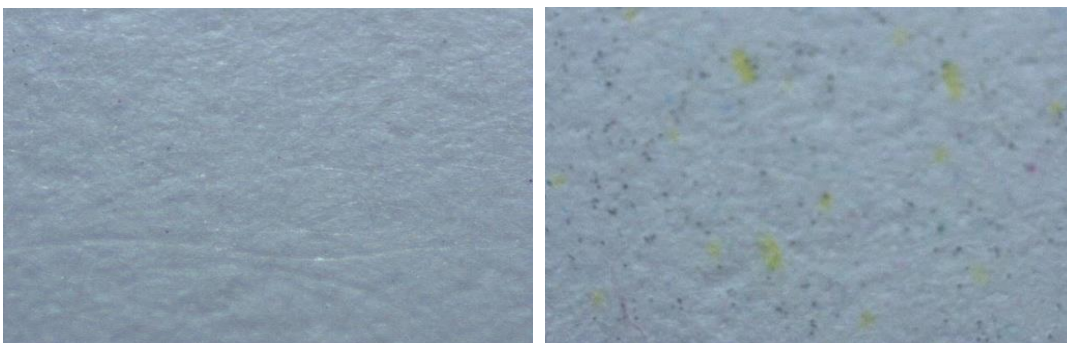
Abbildung A-27: Unbedruckte Seite (links) und bedruckte Seite eines Farb-Laser-Druckers mit Machine Identification Code [Ele-13]
