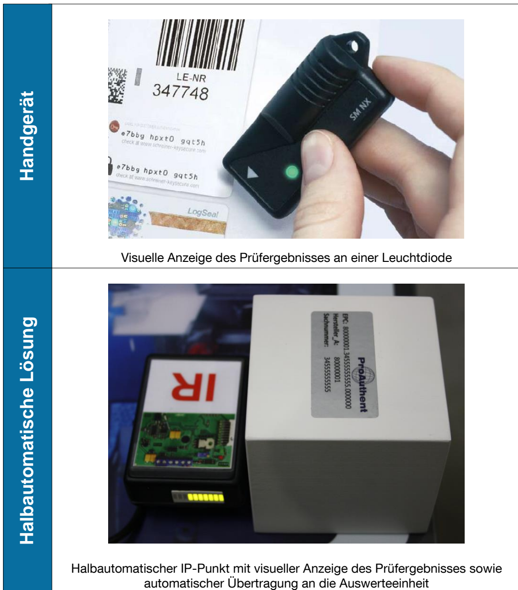
Abbildung 8-5: Weiterentwicklung eines Handgeräts zu einer halbautomatischen Lösung zur Integration an einem IP-Punkt (Bildquelle Handgerät: [Sch-13a])
