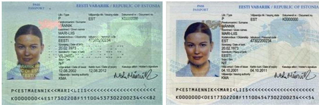
Abbildung A-33: Farbwechsel von photochromer Farbe unter UV-Licht [Rat-13]
