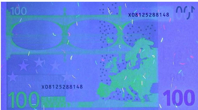
Abbildung A-37: Ultraviolette Farbelemente auf der 100-Euro-Banknote [Deu-13a]
