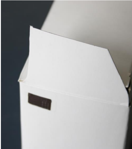
Abbildung A-56: Sicherheitsanstanzung [Gün-11a]
