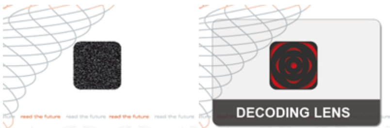
Abbildung A-29: Rasterbild (links) wird durch den Spezialfilter zu einem Prüfmuster [Aus-13a]
