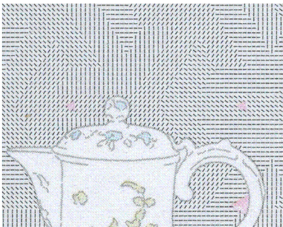
Abbildung A-26: Kopierschutzmuster im Reisepass der Niederlande als feine winkelabhängige Strichstrukturen [Rat-13]
