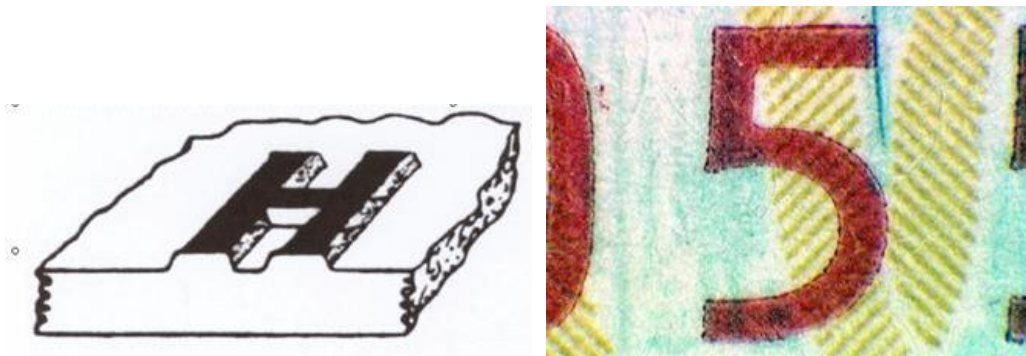
Abbildung A-10: Hochdruckform für Buchstaben (links) und gedruckte Ziffer [Rat-13]
