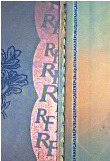
Abbildung A-38: Interferenzfarbe auf dem französischen Reisepass [Rat-13]
