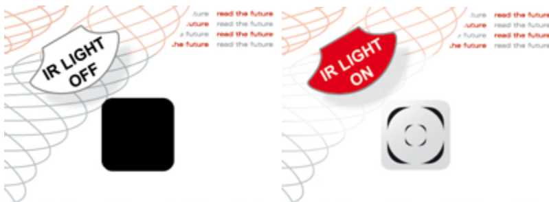
Abbildung A-34: Infrarotfarbe ohne (links) und mit Infrarotlichtbestrahlung [Aus-13a]
