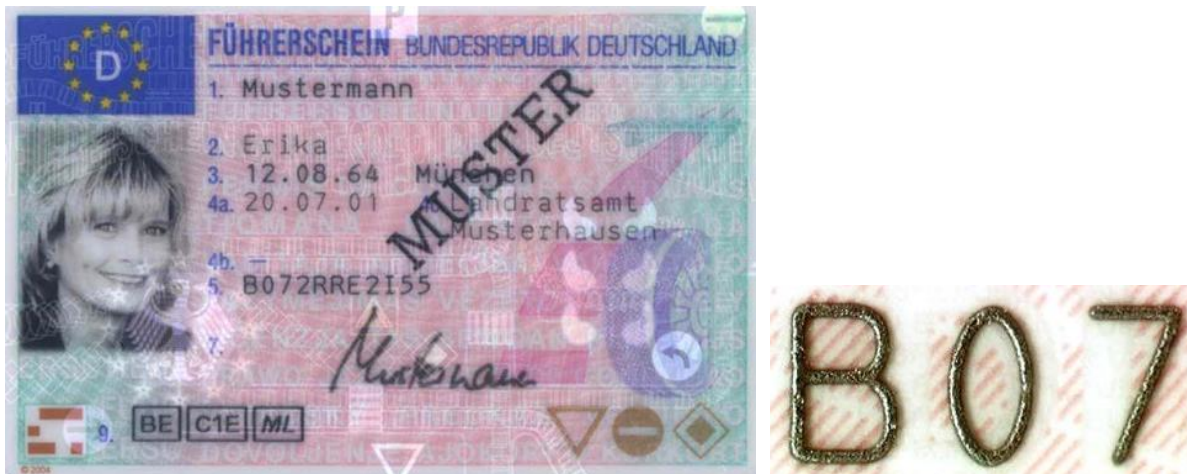
Abbildung A-49: Lasergravur im deutschen Führerschein [Rat-13]
