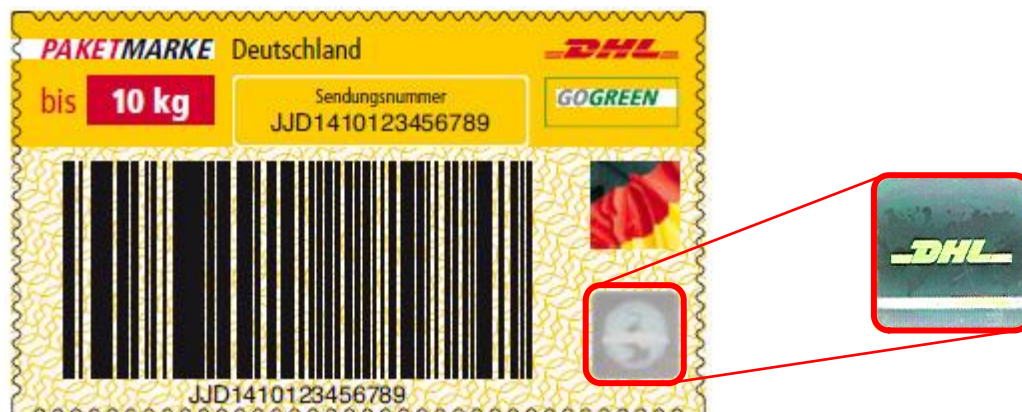
Abbildung 7-19: Unikatkennzeichen als Kombination aus Identitätskennzeichen und Originalitätskennzeichen (Bildquelle Paketmarke: [Deu-13d], Bildquelle Hologramm: eigene Aufnahme)
