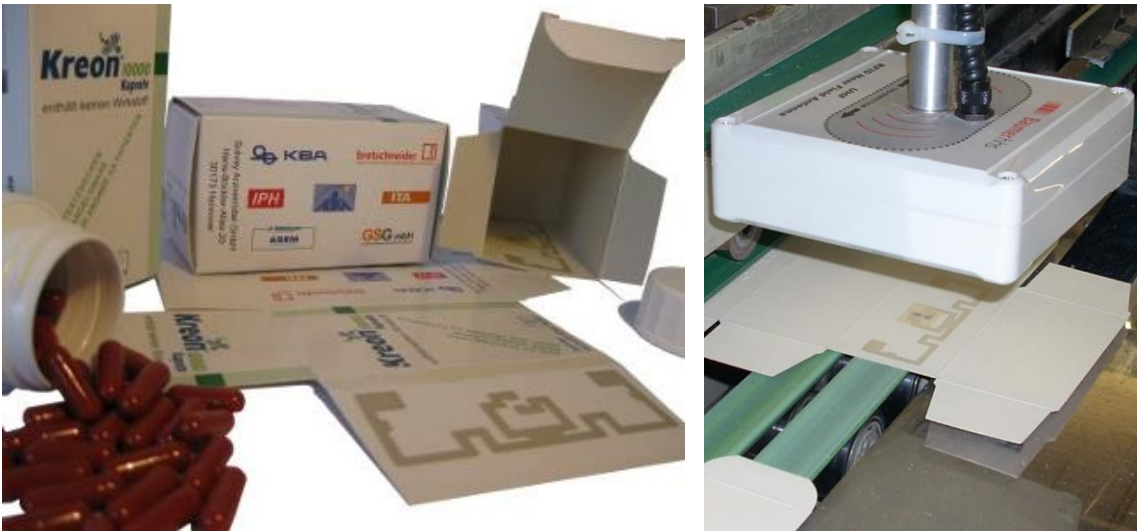
Abbildung 4-1: Faltschachteln für Pharmaprodukte mit RFID-Transponder (links) und Testlesung einer bestückten Faltschachtel [IPH-12 und Abr-10 S. 113]
