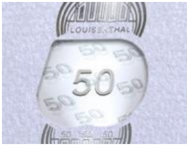
Abbildung A-19: Moiré Magnifier-Element [Gie-13a]
