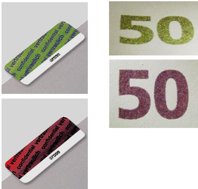
Abbildung A-39: Kippfarbe aus verschiedenen Betrachtungswinkeln – als Prüfelement auf einem Muster (links) oder in Anwendung auf der 50-Euro-Banknote, [Sch-13a] und [Deu-13a]
