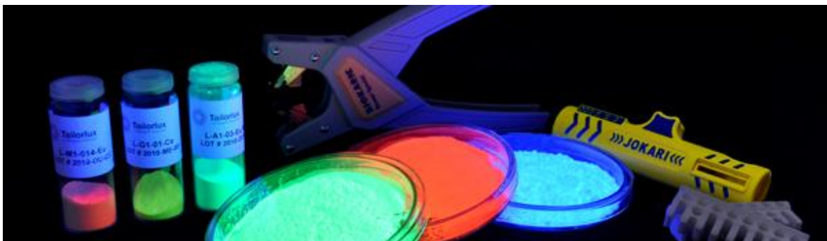
Abbildung A-45: Phosphoreszierende Farbpigmente [Tai-13]
