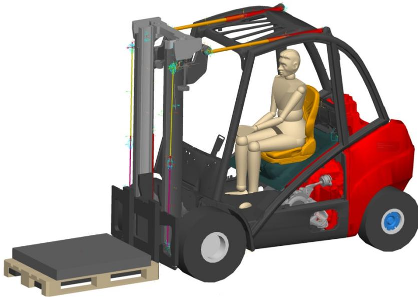
Abbildung 2: Mehrkörpermodell eines Gegengewichtsgabelstaplers mit Fahrer und Sitz
