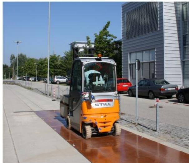
Abbildung 3: Schwellenüberfahrt und Sprunganregung auf der Teststrecke des Lehrstuhls fml
