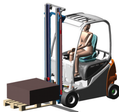
Bild 3 Simulationsmodell eines Gegengewichtsgabelstaplers und Durchführung der Versuche auf der Teststrecke.
