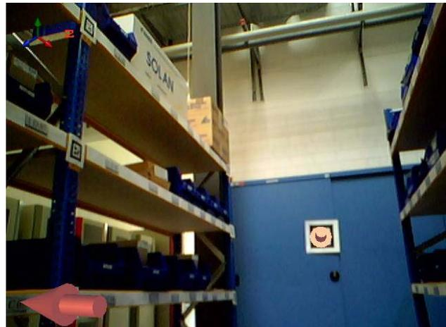
**Abbildung 7-4: Groborientierung an großem Marker, Feinorientierung an kleinem Marker**
