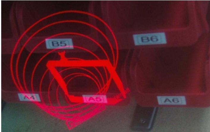
**Abbildung 7-10: Tunnel zur Wegführung und Rahmen um das Lagerfach**
