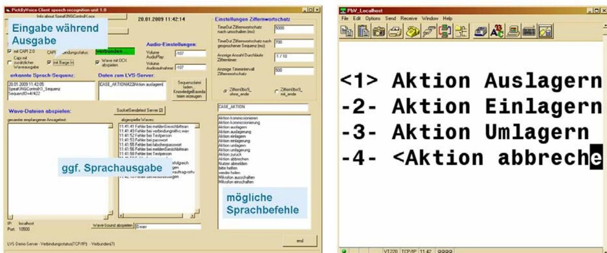
Abbildung 5-3: Sprachkonsole (links) und dazugehörige Anzeige für den Kommissionierer (rechts)
