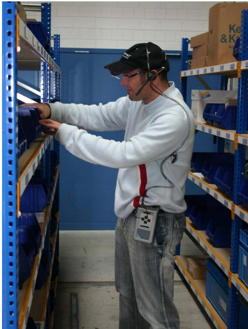
Abbildung 5-4: FM1 mit Datenbrille und Headset für die Sprachinteraktion
