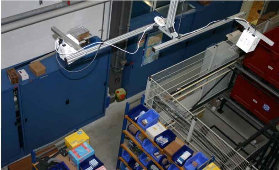
Abbildung 7-12: Trackingkameras über dem Lager
