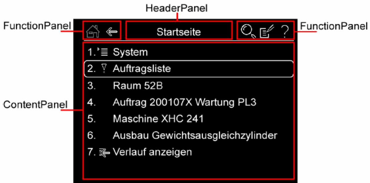
**Abbildung 4-7: generelle Aufteilung der Daten in Inhalt und Navigation bei der Darstellung mit einem HMD [Beu-04]**
