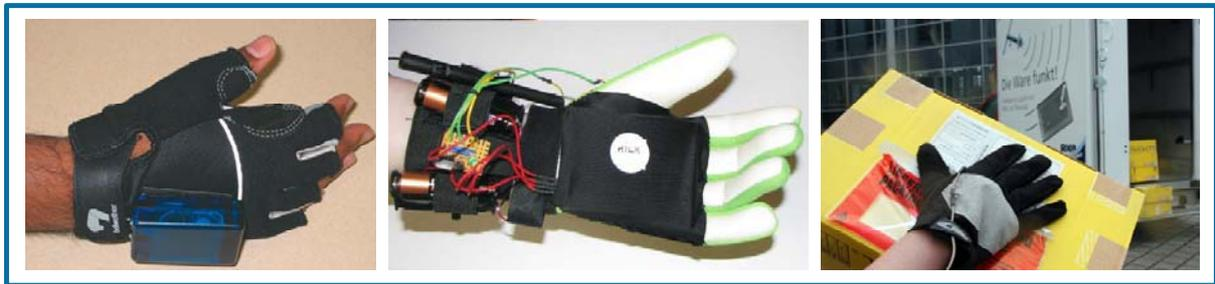
**Abbildung 23: Gestaltung eines tragbaren RFID-Lesegerätes ([Phi-04], [Lus-07], [IFF-10])**
