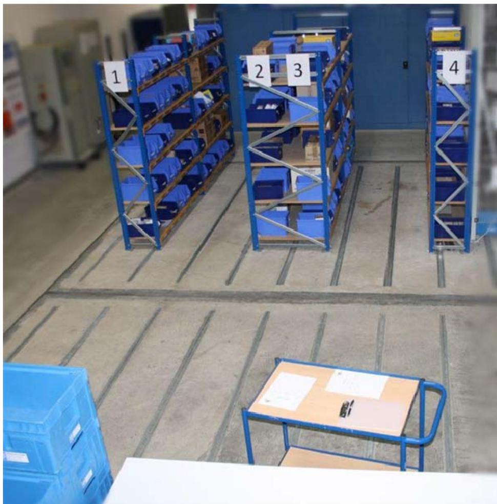
**Abbildung 56: Lagereinrichtung "Fachbodenregallager"**
