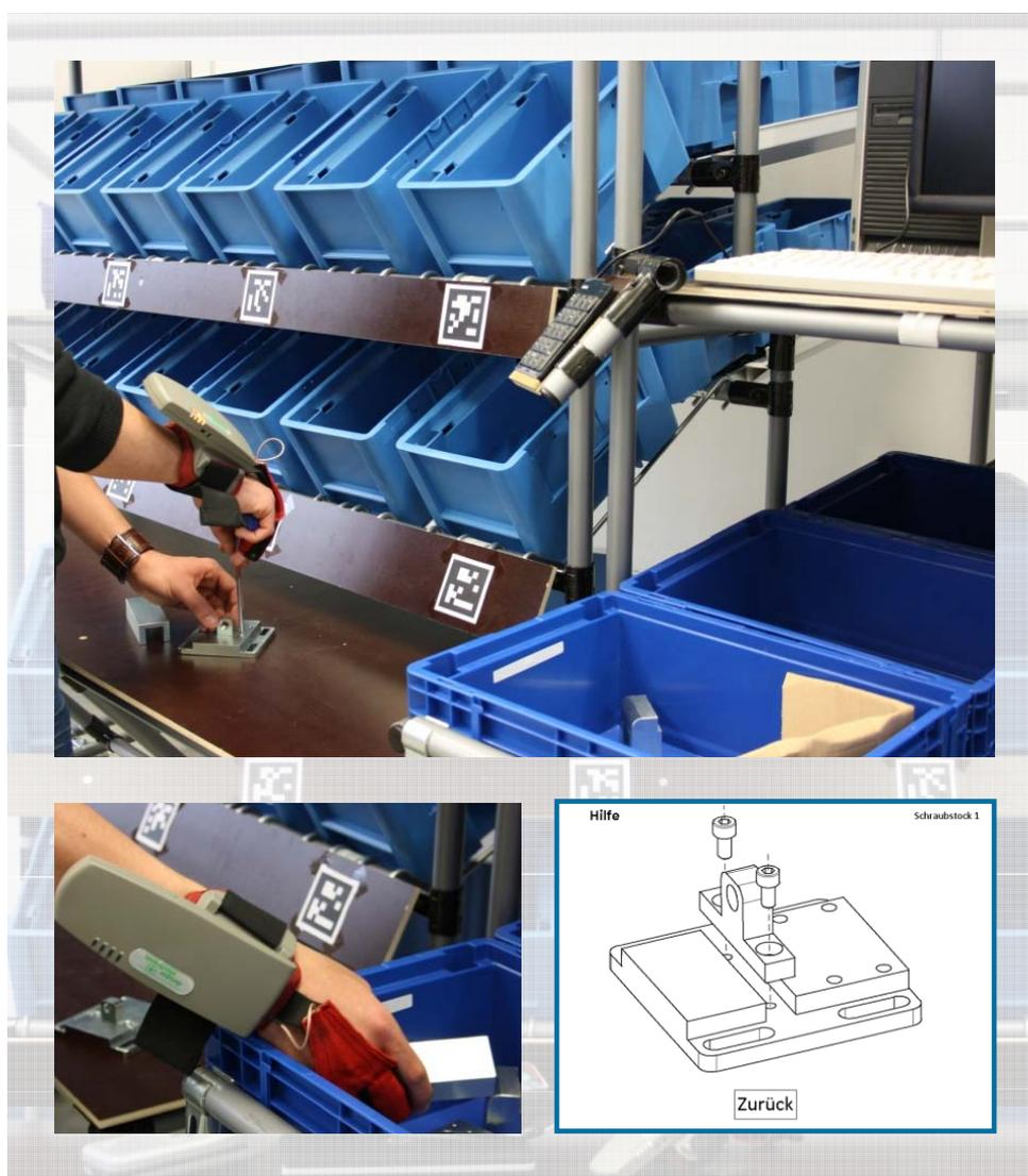
**Abbildung 55: Demonstrator des Funktionsmusters "Montageunterstützung"**
