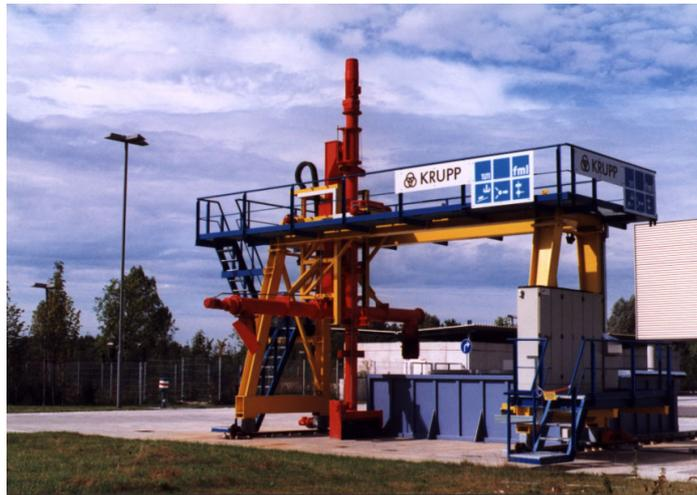
Abb. 1: Versuchsanlage für Hochleistungs-Schneckenförderer am Lehrstuhl fml
