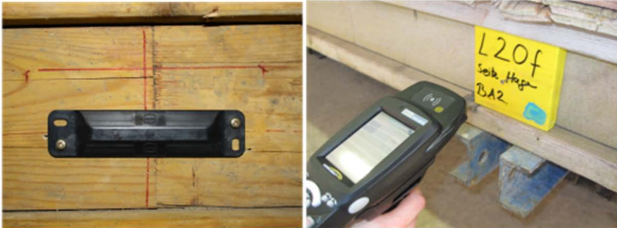
Abbildung 7: Gekennzeichnete Systemschalungen (links Hardtag, rechts Smart Label)
