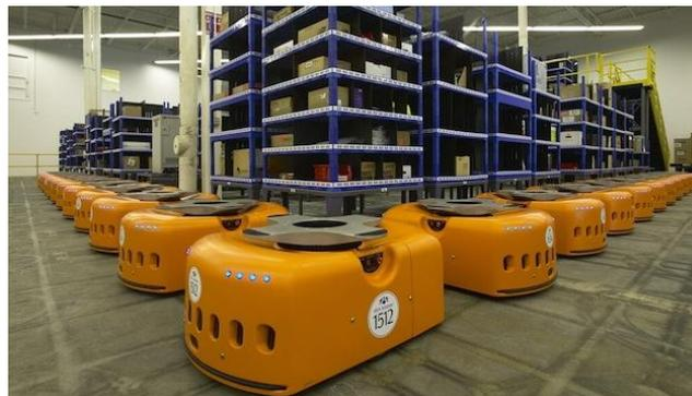
**Abbildung 2-6: Kiva Mobile Fulfillment System (Bildquelle: Kiva)**
