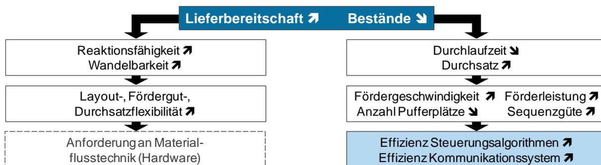
**Abbildung 3-6: Ableitung prozessbedingter Anforderungen an die Fördertechnik in einem Distributionszentrum**
