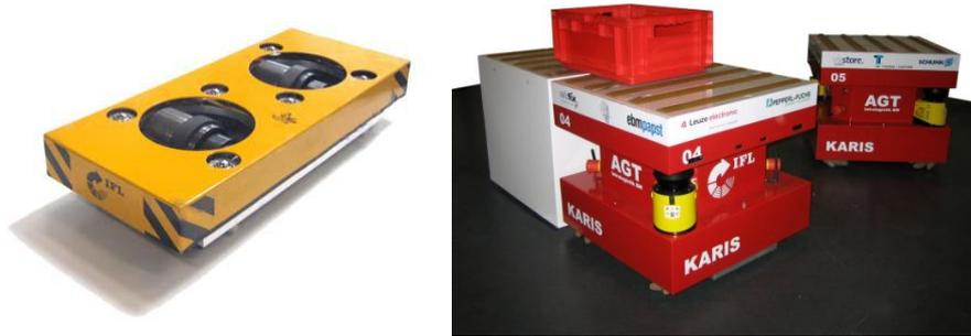
**Abbildung 2-7: BInE (Basic Intralogistic Element, I.) und KARIS (Kleinskaliges Autonomes Redundantes IntralogistikSystem) (Bildquelle: IFL, Karlsruhe)**
