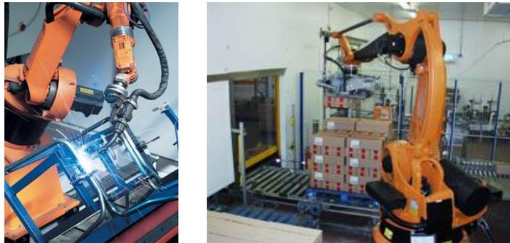
**Abbildung 2-1: Schweißroboter (l.) und Palettierer (Bildquelle: KUKA)**
