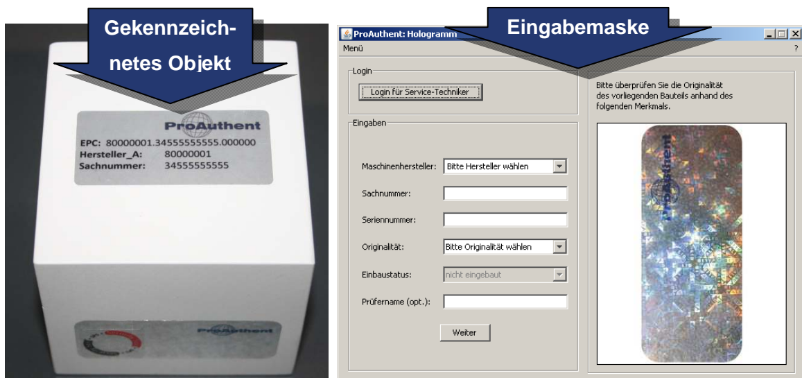
Abbildung 22: IP-Punkt zur Authentifizierung von Produkten, die mit Hologrammen gekennzeichnet sind
