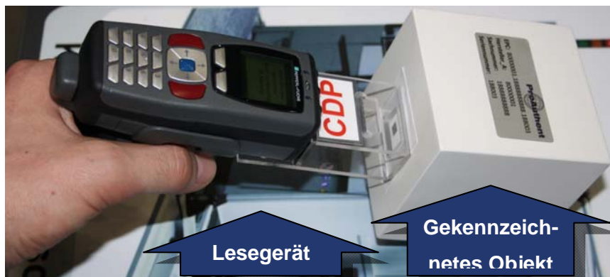
Abbildung 19: Realisierung eines IP-Punkt am Demonstrator des Lehrstuhl fml zur Authentifizierung von Produkten, die mit CDP gekennzeichnet sind
