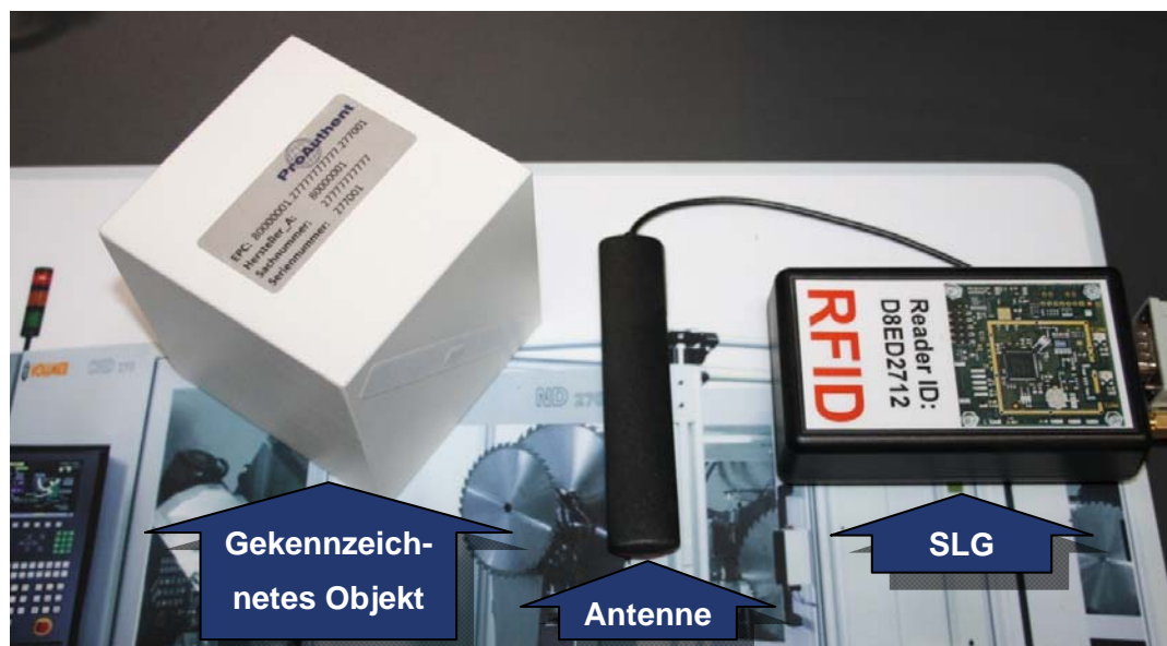
Abbildung 17: Realisierung eines IP-Punkts am Demonstrator des Lehrstuhls fml zur Authentifizierung von Produkten, die mit RFID gekennzeichnet sind
