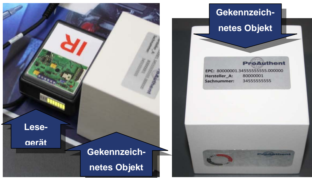
Abbildung 21: Realisierung eines IP-Punkt am Demonstrator des Lehrstuhl fml zur Authentifizierung von Produkten, die mit IR-Farbe gekennzeichnet sind
