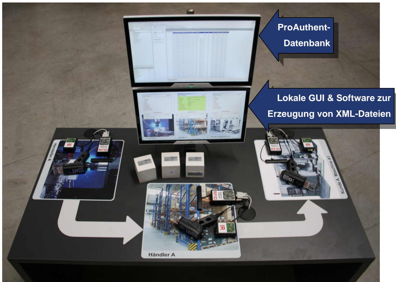
Abbildung 29: Realisierung einer geschützten Wertschöpfungskette als Demonstratorsystem des Lehrstuhl fml mit drei IP-Punkten
