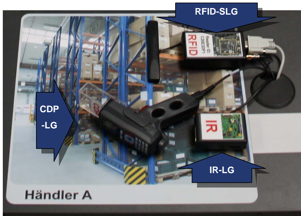
Abbildung 25: Realisierung eines integrierten IP-Punkts für RFID, CDP, IR-Farben und Hologramme am Demonstrator des Lehrstuhl fml (Hologramme werden mittels manueller Eingabe erfasst)
