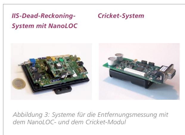
Abbildung 3: Systeme für die Entfernungsmessung mit dem NanoLOC- und dem Cricket-Modul
