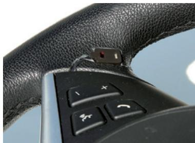
Abbildung 3: Lenkradintegrierter Sensor zur Messung von Hautwiderstand (links) und Pulsoximetrie (rechts)
