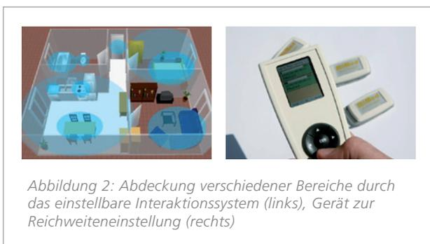
Abbildung 2: Abdeckung verschiedener Bereiche durch das einstellbare Interaktionssystem (links), Gerät zur Reichweiteneinstellung (rechts)
