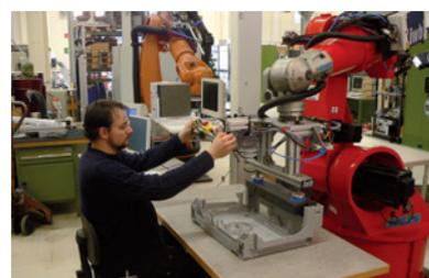
Abbildung 2: Führen des Roboters durch Greifen am Bauteil (links), vereinfachtes Modell des Führverhaltens. Bereich I, II Feinpositionieren, IV Grobpositionieren, III Wechsel zwischen Fein- und Grobpositionierung, V Grenzgeschwindigkeit. ( $v$ -Geschwindigkeit,  $F$ -Kraft,  $dF$ -Kraftänderung) (mitte).
