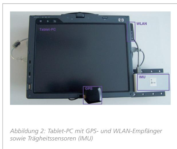
Abbildung 2: Tablet-PC mit GPS- und WLAN-Empfänger sowie Trägheitssensoren (IMU)
