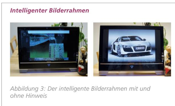
Dieser Demonstrator erweitert die Funktionalität heutzutage üblicher digitaler Bilderrahmen. Mit neuen, integrierten Interaktionsquellen, wie einer Kamera und einem Touchscreen, können der Blickfokus sowie auffällige Emotionen des Betrachters analysiert werden. Bei Bildern
