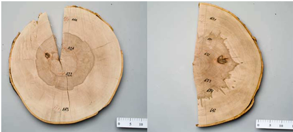
Abbildung 4: Rot- (links) bzw. Spritzkern (rechts) bei Buche
