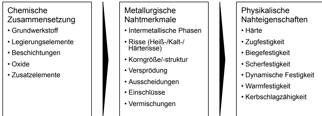
Abbildung 3: Einfluss der Nahtzusammensetzung auf die physikalischen Eigenschaften
