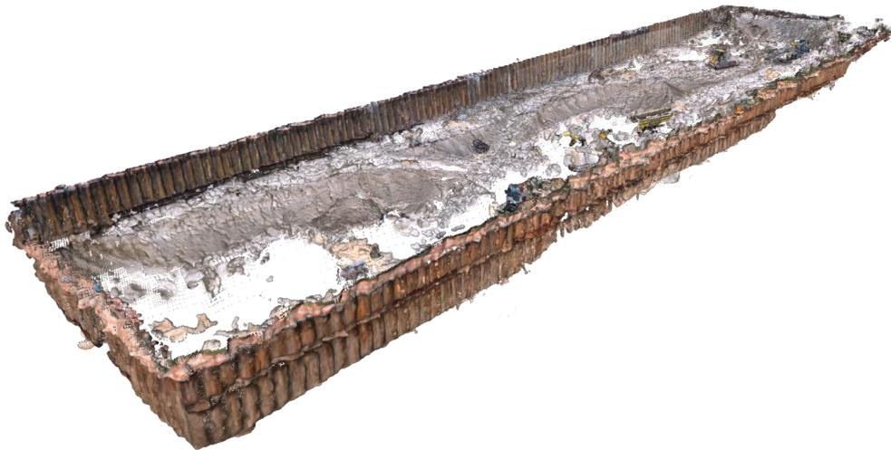
Abbildung 8: Fotogenerierte Punktwolke der Baugrube aus Abbildung 6
