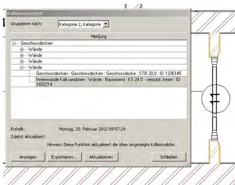
**Abbildung 5.14:** Ergebnis der Kollisionsanalyse zwischen Wänden und Geschossdecken.
