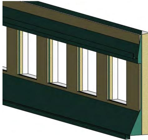
Abbildung 6.3: Profilierte Wand mit Profilversatz um 10, 0 cm in Richtung des Wandquerschnitts und aktiver „Schneidet Wand“ Spalte.
