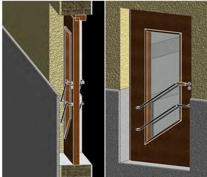
**Abbildung 6.10: Außentür Typ 3, platziert in eine Erdgeschosswand mit negativem Versatz von 1,0 m. Im Bereich der Kellerwand ist zusätzlich ein Wandprofil angebracht. Im linken Bild wird dieses beim Einbau der Tür nicht ausgeschnitten. Im rechten Bild wird es wie gewünscht ausgeschnitten.**
