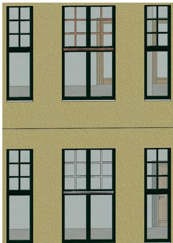
Abbildung 5.26: Steuern der Materialien einzelner Elemente mithilfe von Parametern mit Exemplar- und Typeneigenschaften.
