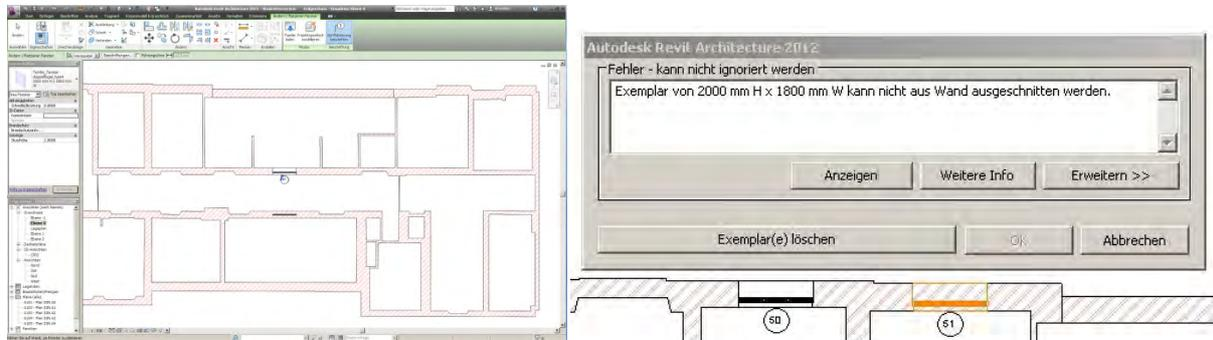
**Abbildung 6.6:** Durch den großen Projektkörper kann Revit nicht mehr beurteilen, wo das Fenster eingebaut werden soll. In diesem Fall wird es in den Flur platziert, obwohl der Cursor über der unteren Außenwand liegt (links). Revit baut das Fenster zwar in den Projektkörper, es kann jedoch nicht aus ihm heraus geschnitten werden (rechts).
