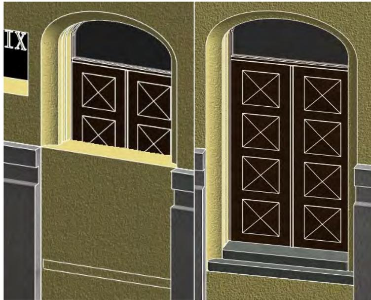
Abbildung 6.9: Außentür-Typ 1, platziert in einer Erdgeschosswand mit negativem Versatz von 1,60 m. Im linken Bild wird nur die geschnittene Erdgeschosswand ausgeschnitten. Im rechten Bild werden Erdgeschoss- und Kellerwand ausgeschnitten.
